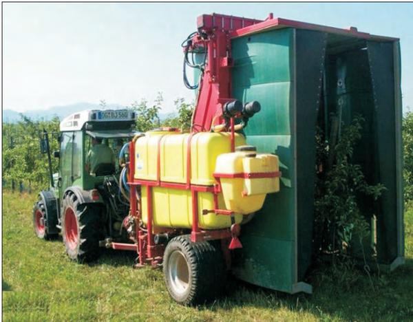
*Tunnelspritzgerät im Obstbau zur Abdriftreduktion*
